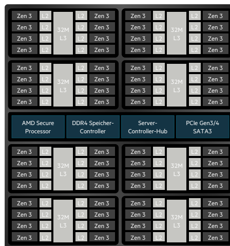
Abbildung 4. High-Level-Design des Prozessors der AMD EPYC 7003-Serie 6
