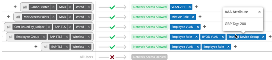
Figura 7. Le policy applicate per VLAN, policy basate su gruppi e ruoli utente sono facilmente visibili
