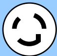
左図 : UPS R/T3000 G5 (200V) の入力電源プラグの形状 ツイストロック コネクター 【NEMA L6-20P】
