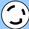
UPS R/T3000 G5 (100V)の入力電源プラグの形状 ツイストロック コネクタ【NEMA L5-30P】 (NEMA L6-30P と NEMA L5-30P は プラグの大きさが異なります)
