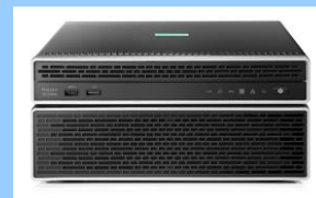
TM200 本体にストレージ 拡張ボックスを装着した状態
